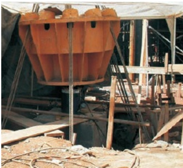
Figura 2. Prova de Carga pelo método Convencional reaginado contra cordoalhas.
